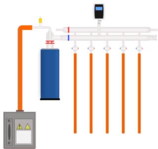
Consiste en dos tubos de vidrio paralelos conectados entre sí mediante varias llaves de tres vías. Una de las líneas se conecta a una bomba de vacío y la otra a una fuente de gas inerte (nitrógeno o argón)
