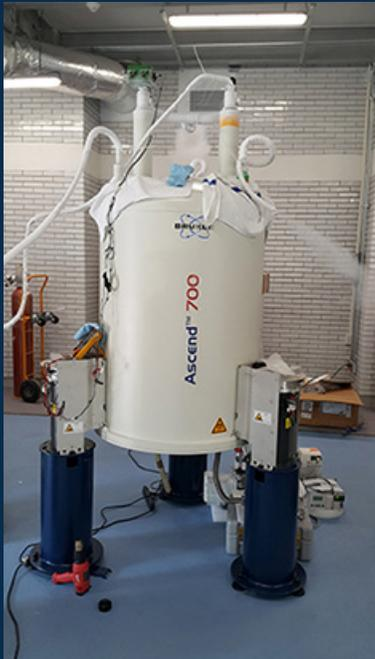
Enfriamiento con nitrógeno y helio líquidos.
