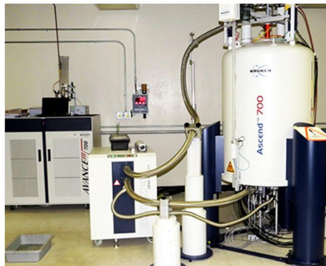
Equipo de RMN de 700 MHz con microcriosonda.
