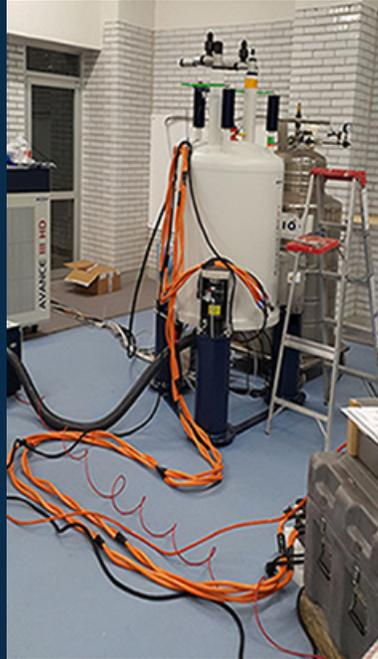
Energización del magneto de 500 Mhz para generar el campo
