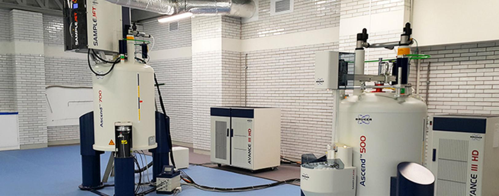
Equipo de 700 MHz y el Equipo de 500 MHz parte del Laboratorio Universitario de Resonancia Magnética Nuclear.
